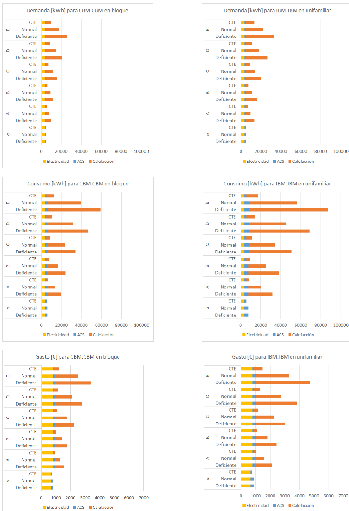
Fig 8. Demanda, consumo y gasto en instalaciones con biomasa.
